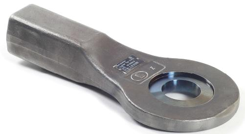
Die Zugöse ist geeignet zur Verwendung an Anhängern mit starrer und vertikal schwenkbarem Zugeinrichtungen.
